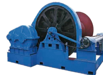
中海油基地拖船用 JM30吨卷扬机 容绳量：2000m 额定速度：10m/min
